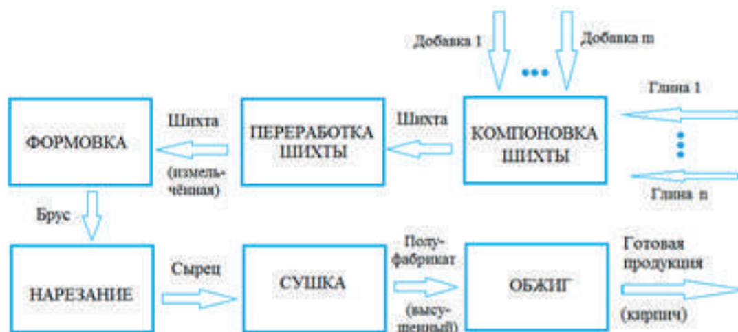
Рис 2. Структурная схема производства керамического кирпича.
